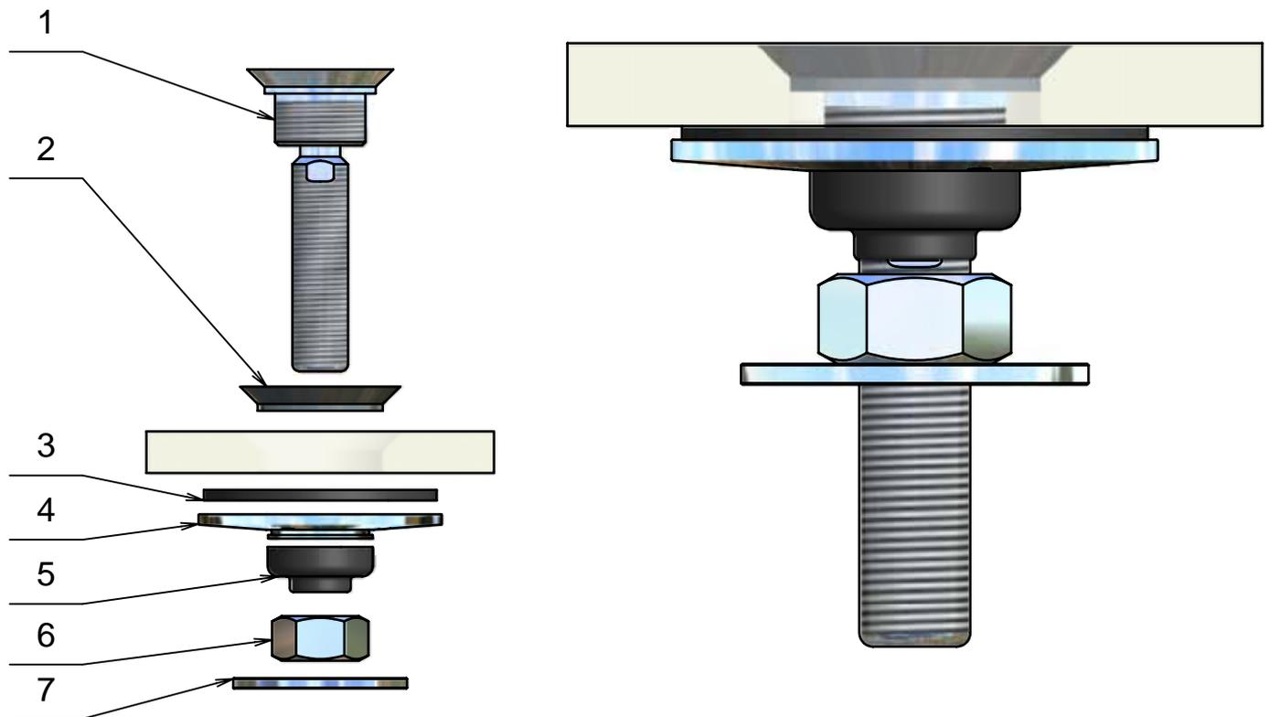
**ACHTUNG:** Grundsätzlich sind alle Schraubverbindungen mit geeigneten Mitteln (z.B. Loctite) zu sichern!
