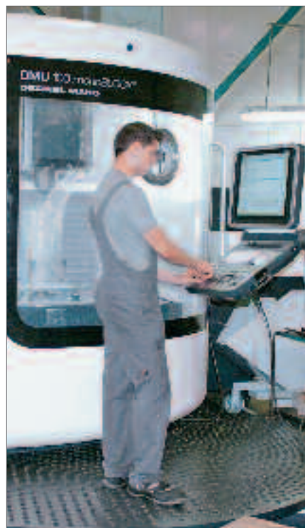
Die Bauteile von Gebo und Osp werden mithilfe modernster CNC-Technik bearbeitet. Das Foto zeigt Zerspanungstechniker Karl Fuchs, der eine Maschine programmiert.
