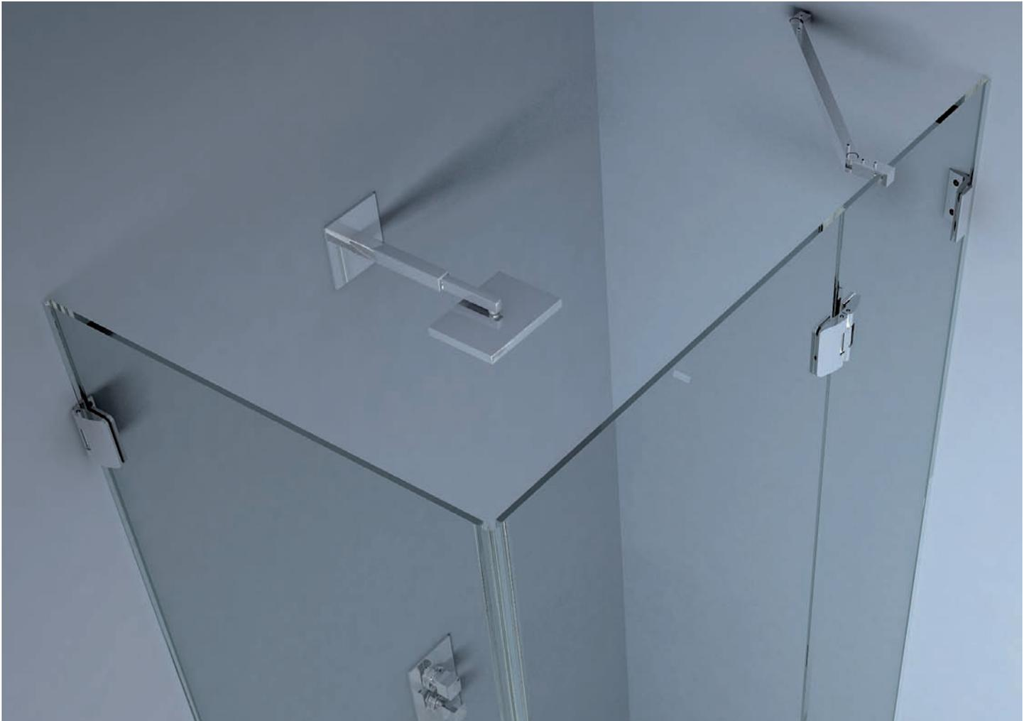
Die Anschlagtürbänder der Serie 856 ermöglichen die einseitige Öffnung der Duschtür nach außen. Die Selbstschließung erfolgt auf den letzten 15°. Die spezielle Form der seitlichen Befestigungsplatte ermöglicht die seitliche Dichtung im Bandbereich durchlaufen zu lassen und somit eine einwandfreie Wasserdichtigkeit zu sichern.
