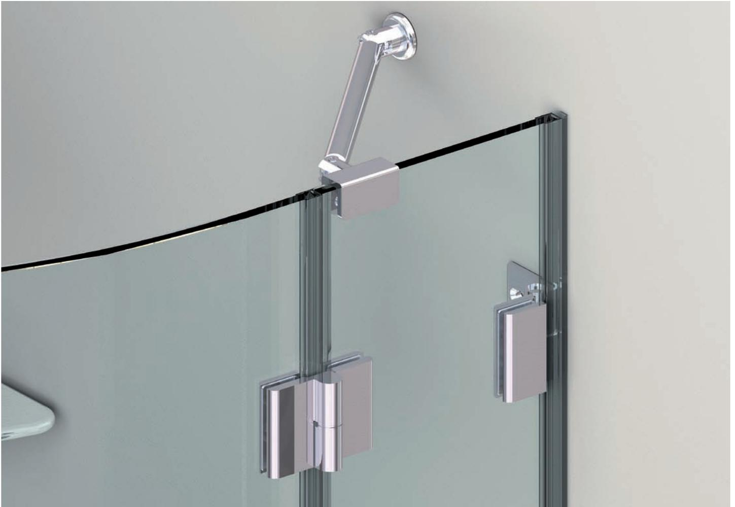
BoxCurvo ist das System für Rundduschen mit halbrunden, gebogenen zweiflügeligen Glastüren. Das Beschlagsset beinhaltet die Verbindungswinkel Glas-Wand, die Türbänder für Links und Rechts mit Hebe-Senk-Funktion und die erforderlichen gebogenen Dichtungen, um die Wasserdichtigkeit im unteren Bereich optimal zu gewährleisten.
