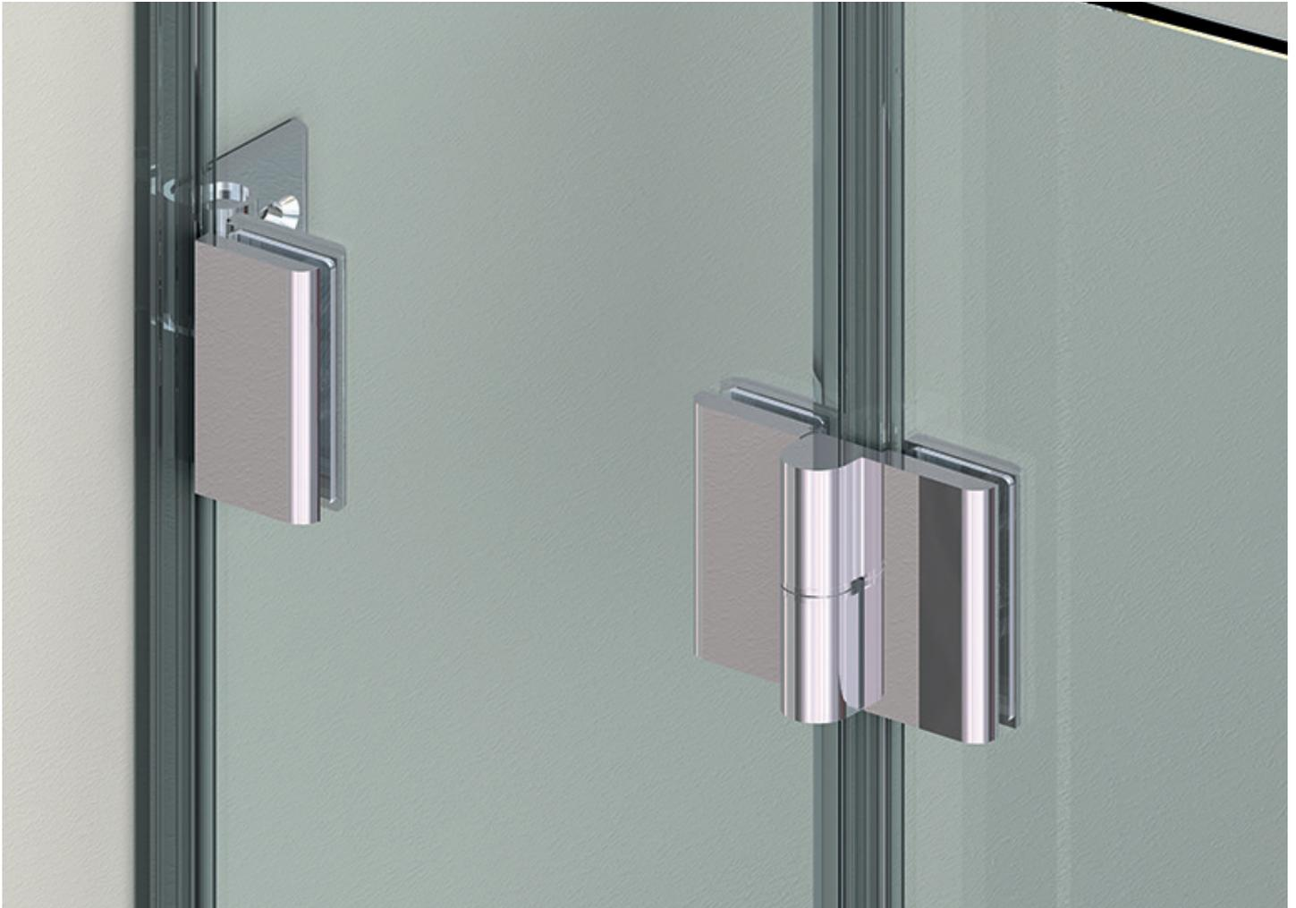
Die Anschlagtürbänder in den Varianten Glas-Wand und Glas-Glas sind mit einer Hebe-Senk-Funktion ausgestattet. Die kleinen Abmessungen und die Leichtigkeit der Bänder werden besonders geschätzt. Der Mechanismus erlaubt das Umklappen der Glastür um 180°. Die Wasserdichtigkeit des Systems wird durch die Hebe-Senk-Funktion und die untere Dichtung erzielt.
