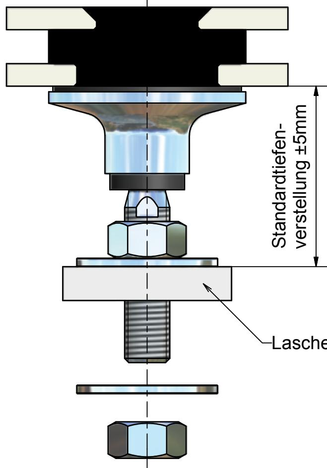
**ACHTUNG:** Grundsätzlich sind alle Schraubverbindungen mit geeigneten Mitteln (z.B. Loctite) zu sichern!
