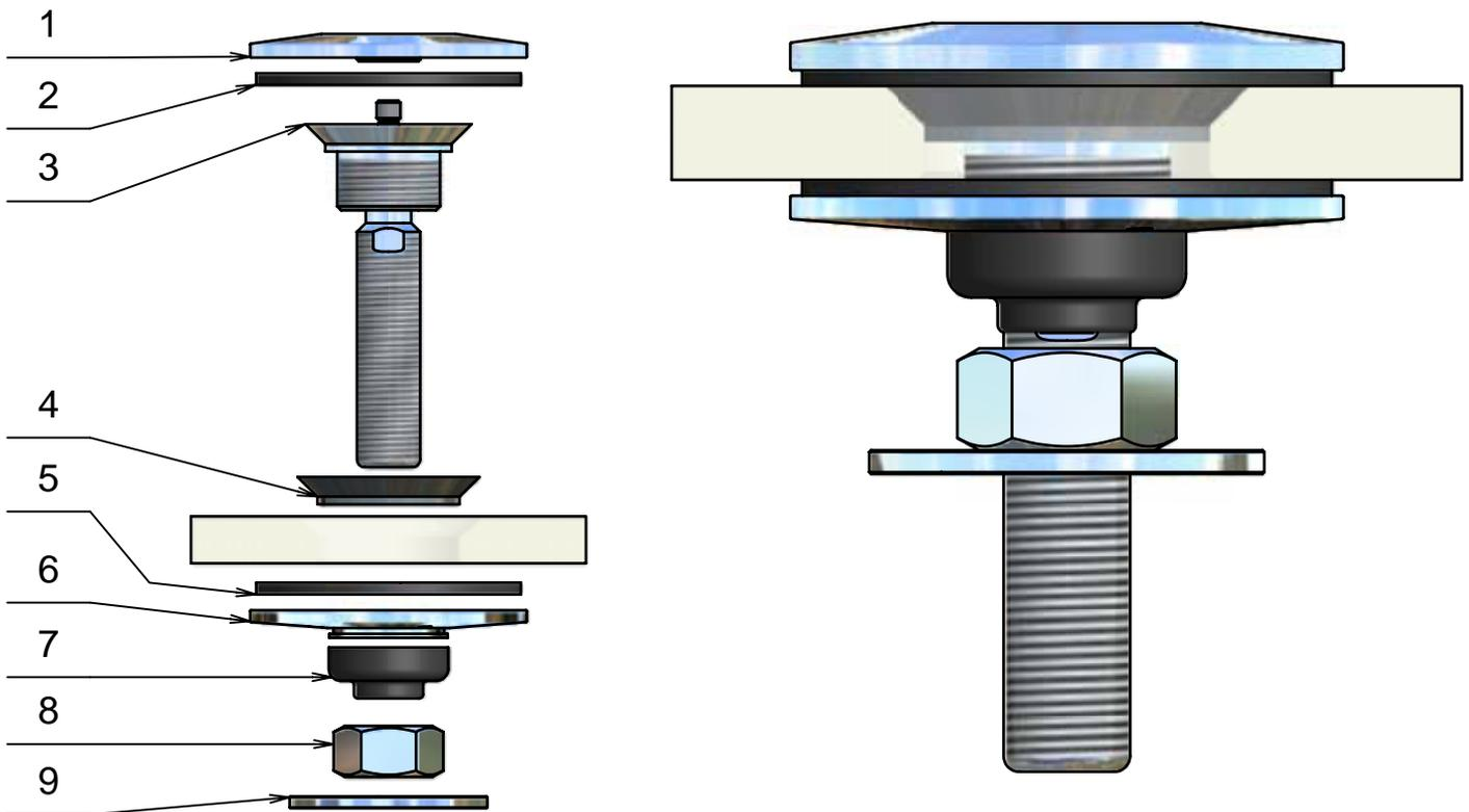
**ACHTUNG:** Grundsätzlich sind alle Schraubverbindungen mit geeigneten Mitteln (z.B. Loctite) zu sichern!
