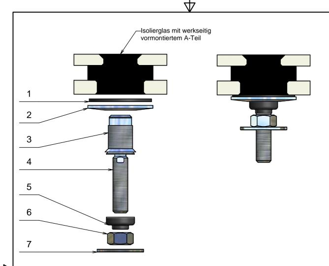
ACHTUNG: Grundsätzlich sind alle Schraubverbindungen mit geeigneten Mitteln (z.B. Loctite) zu sichern!
